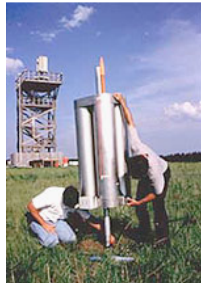
b. Préparation de la fusée qui va déclencher la foudre.
