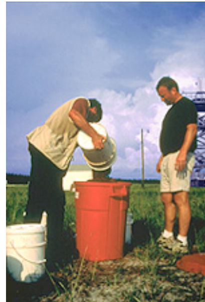
a. Remplissage avec du sable de Floride du récipient destiné à recevoir le coup de foudre.
